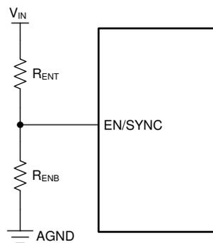
图 9-1.  $V_{IN}$  UVLO Using the EN pin
