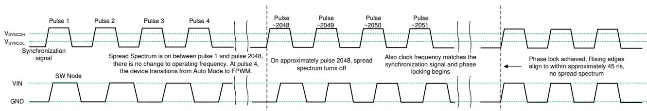
图 9-4. Synchronization Process
