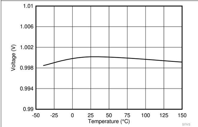
图 8-3. Feedback Voltage
