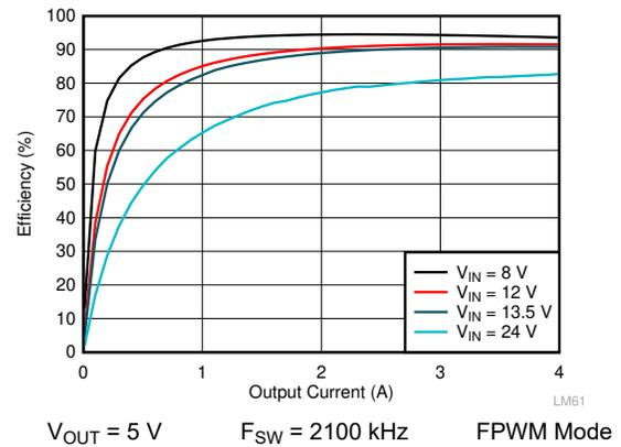
图 10-8. LM61440-Q1 Efficiency
