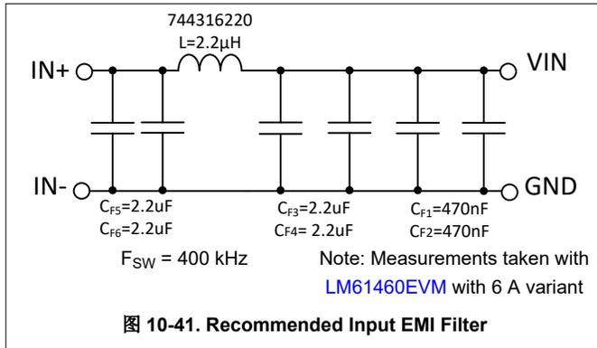
图 10-41. Recommended Input EMI Filter
