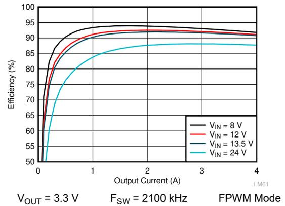
图 10-6. LM61440-Q1 Efficiency
