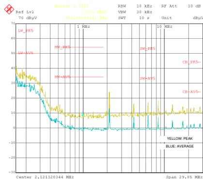
传导 EMI : V<sub>OUT</sub>=5V, f<sub>SW</sub>=2100kHz
