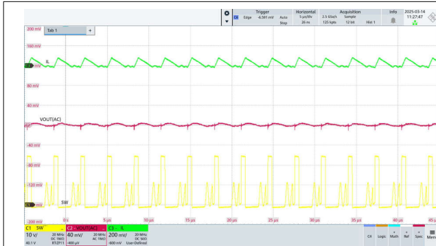
图 7-8. DCM Steady State Ripple
