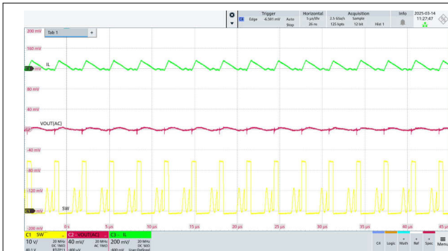
图 7-8. DCM Steady State Ripple
