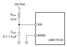
图 9-11. VIN Pin Configuration
