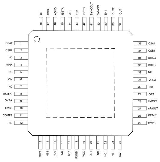
图 6-1. PHP Package 48-Pin TQFP Top View
