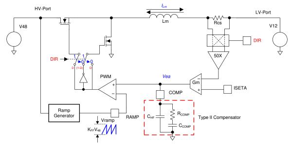
图 9-3. Control Loop Block Diagram
