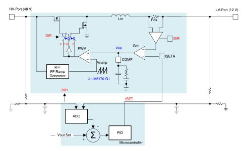
图 9-7. Digital Outer Voltage Loop Control
