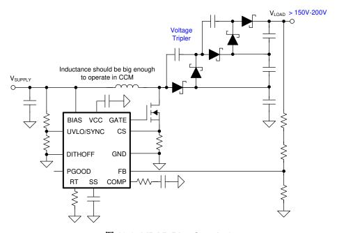
图 10-8. LIDAR Bias Supply 2
