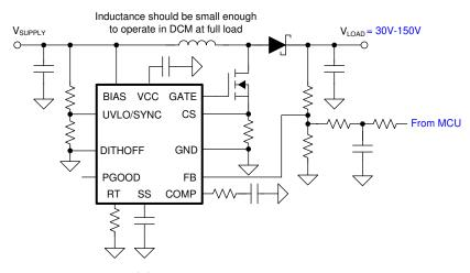
图 10-7. LIDAR Bias Supply 1
