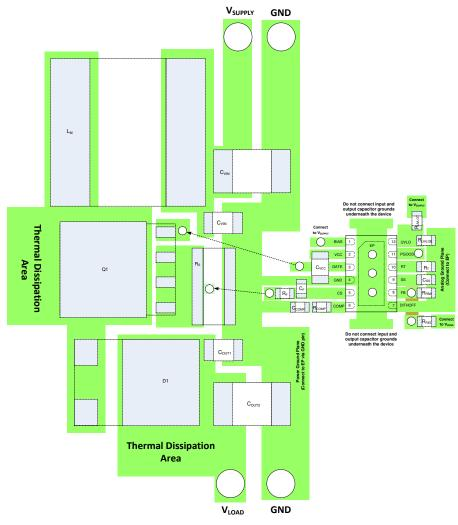
图 12-1. PCB Layout Example 1
