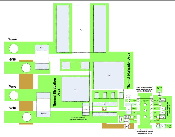
图 12-2. PCB Layout Example 2
