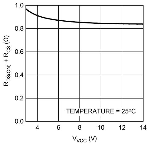
图 6-5. R<sub>DS(ON)</sub> vs V<sub>CC</sub>
