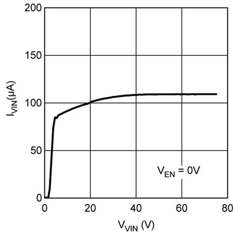
图 6-3. I<sub>Q</sub> (Non-Switching) vs V<sub>IN</sub>
