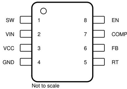
图 5-1. D Package 8-Pin SOIC Top View
