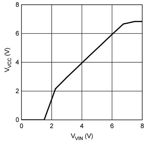
图 6-4. V<sub>CC</sub> vs V<sub>IN</sub>
