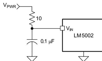
**图 8-1. Input Transient Protection**
