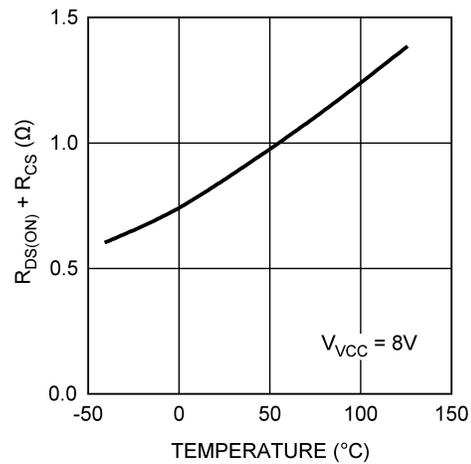
图 6-6. R<sub>DS(ON)</sub> vs Temperature
