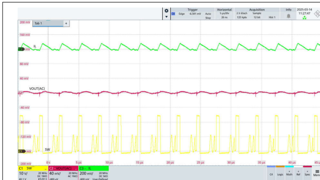
图 7-8. DCM Steady State Ripple
