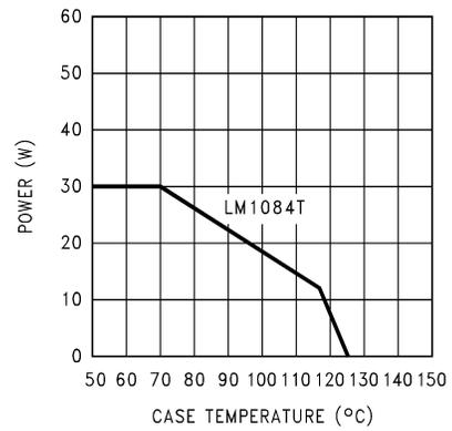
图 5-10. Maximum Power Dissipation
