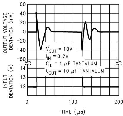
图 5-9. LM1084-ADJ Line Transient Response
