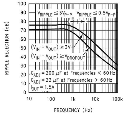
图 5-4. LM1084-ADJ Ripple Rejection
