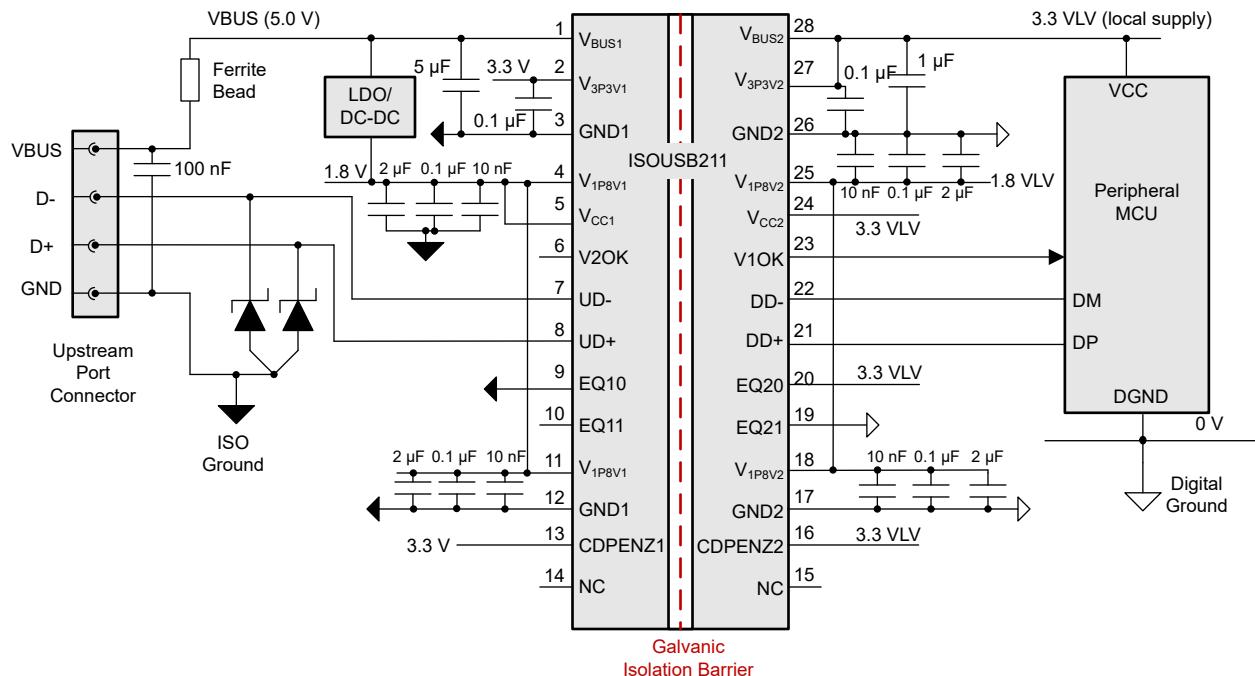
图 8-2. 采用 ISOUSB211 的隔离式自供电外设
