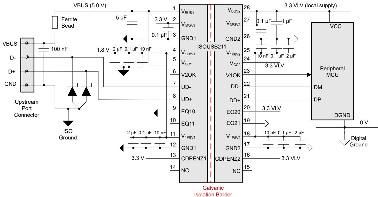
图 8-6. 不搭配外部 1.8V 稳压器使用 ISOUSB211
