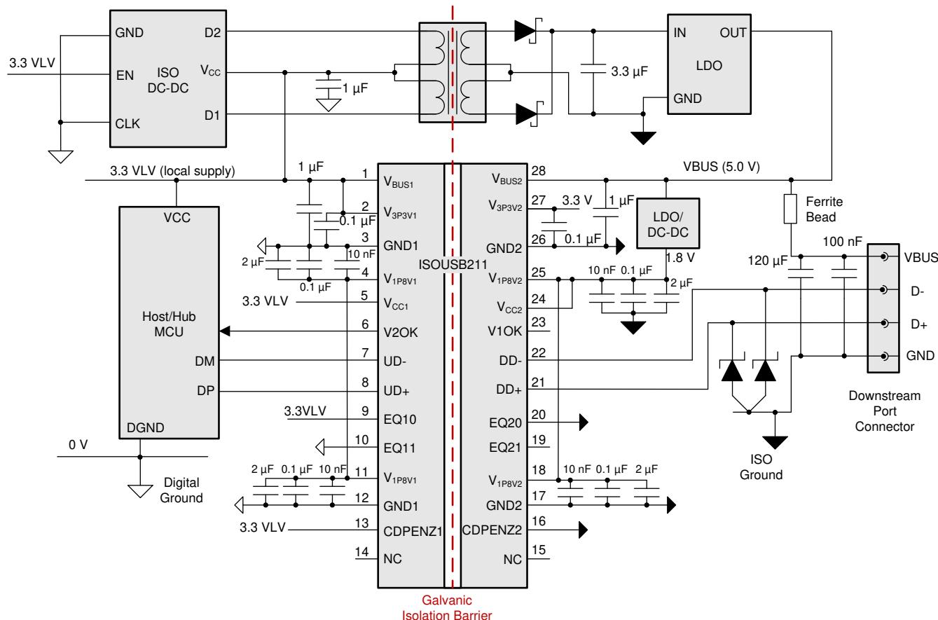
图 8-1. 采用 ISOUSB211 的隔离式主机或集线器
