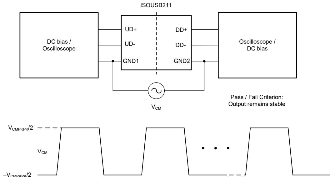
图 6-3. 共模瞬态抗扰度测试电路
