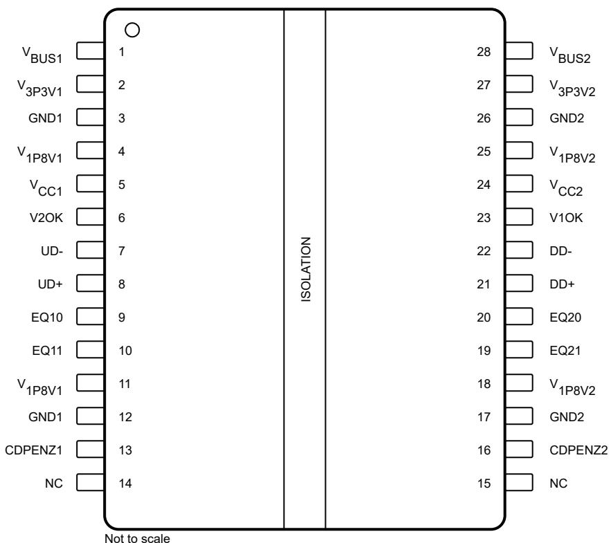
图 4-1. DP 封装 28 引脚 SSOP 顶视图
