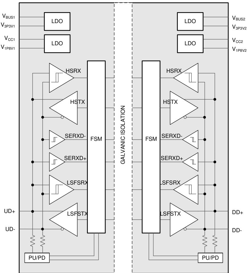
图 7-1. ISOUSB211 简化功能方框图
