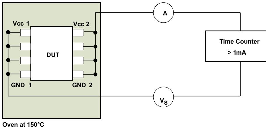
图 8-4. 绝缘寿命测量的测试设置
