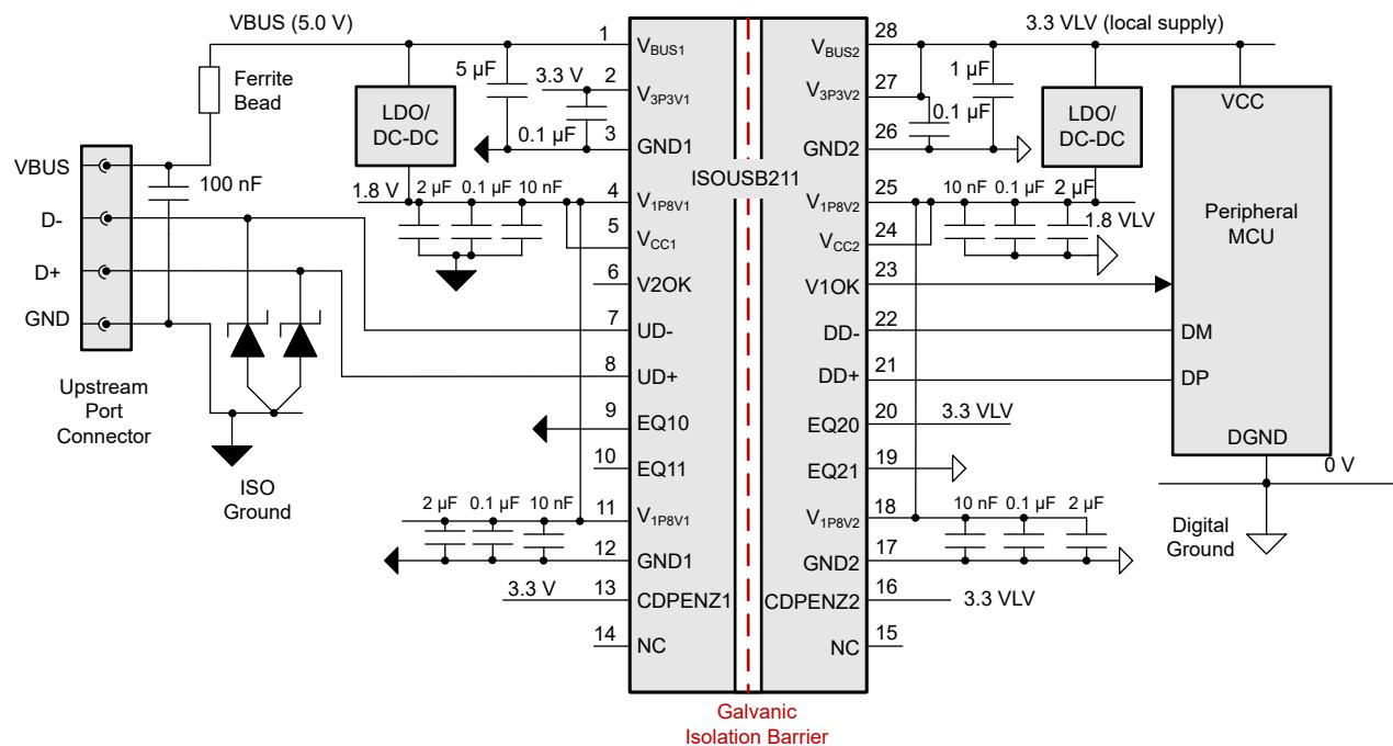
图 8-7. 搭配外部稳压器提供的 1.8V 电源使用 ISOUSB211
