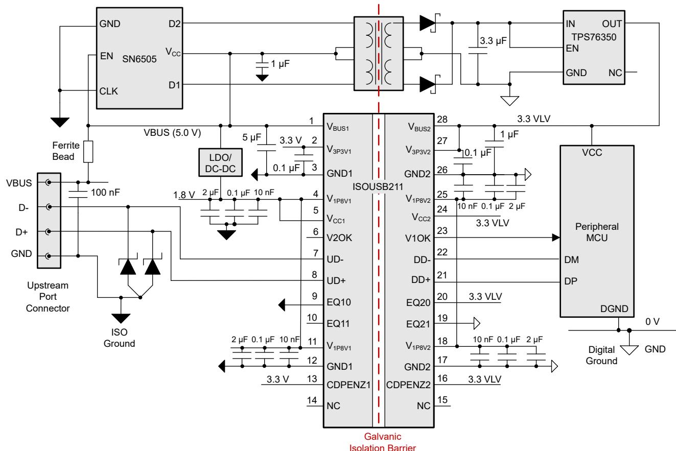
图 8-3. 采用 ISOUSB211 的隔离式总线供电外设
