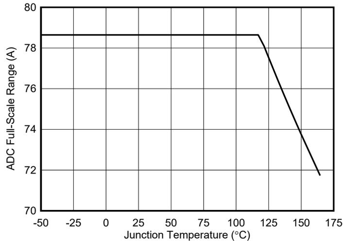
图 8-1. 最大 ADC 电流读数与结温间的关系
