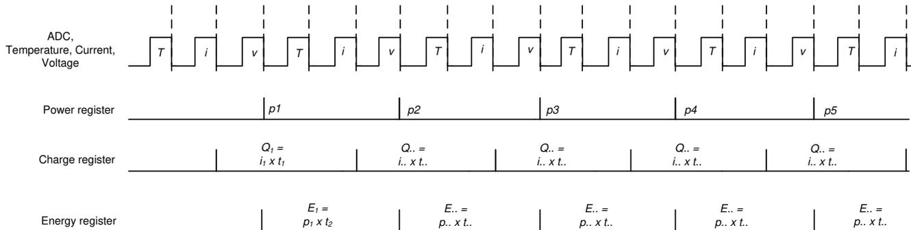
图 7-4. 功率、电能和电荷计算方案
