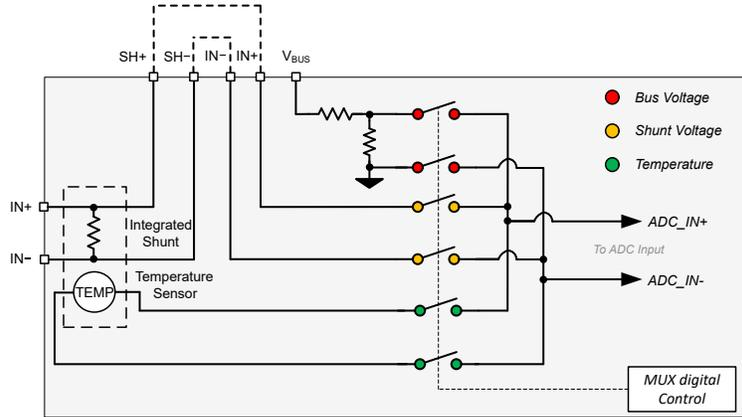
图 7-3. 高压输入多路复用器
