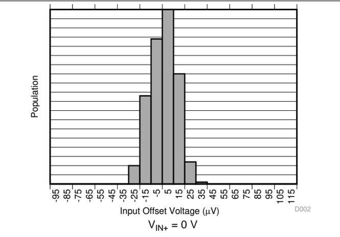
图 2. Input Offset Voltage Production Distribution (INA381A2)
