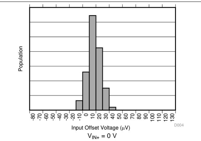
图 4. Input Offset Voltage Production Distribution (INA381A4)
