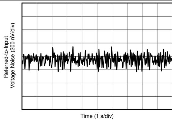
图 26. 0.1-Hz to 10-Hz Voltage Noise (Referred-to-Input)
