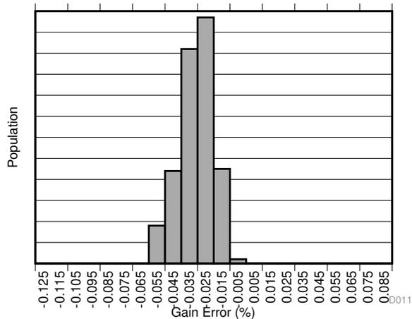
图 11. Gain Error Production Distribution (INA381A1)
