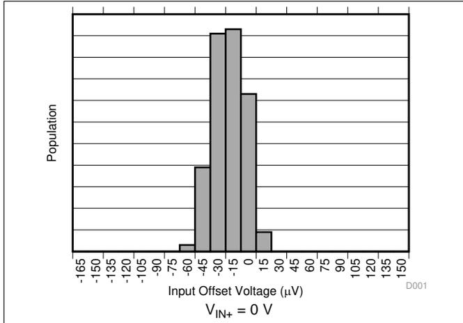
图 1. Input Offset Voltage Production Distribution (INA381A1)
