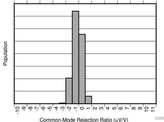
图 9. Common-Mode Rejection Production Distribution (INA381A4)
