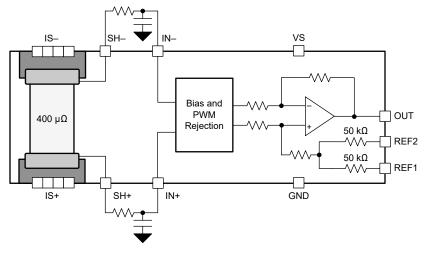
图 9-1. Filter at Input Pins
