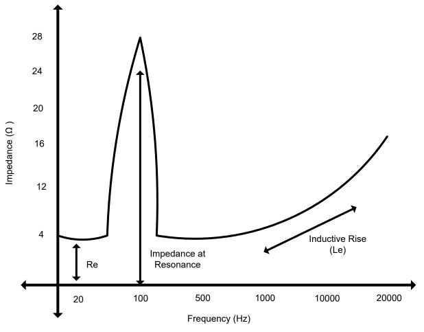
图 9-4. Speaker Impedance Measurement
