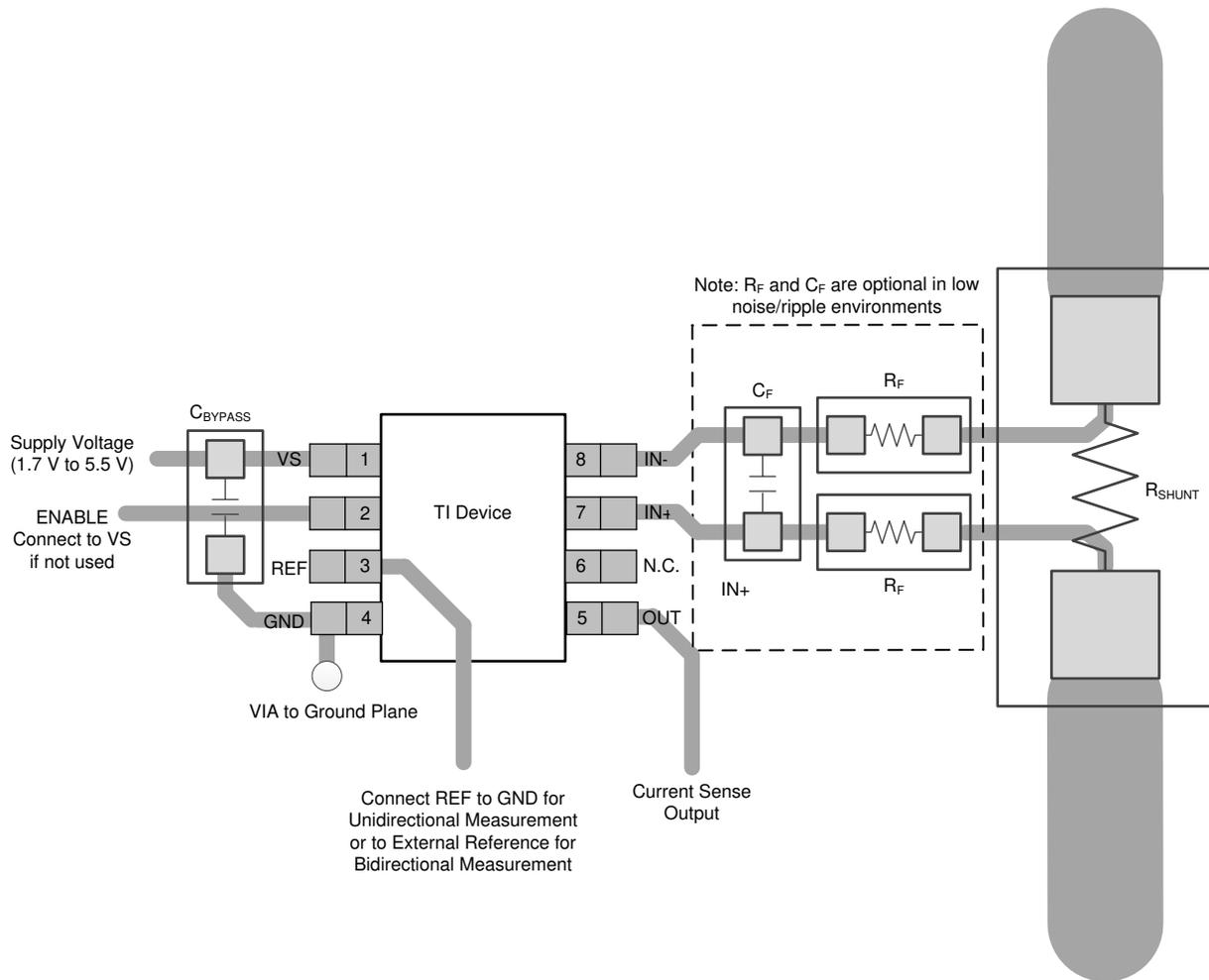
图 47. Recommended Layout for SOT23-8 (DDF) Package
