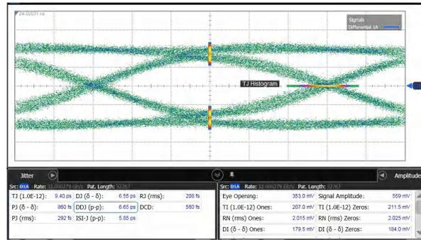
图 6-6. Through DS320PR810 (7 dB Loss and DUT EQ = 0)
