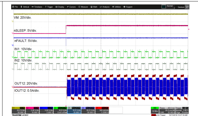
图 8-6. 通过 nSLEEP 引脚实现器件上电
