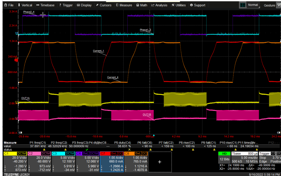
图 8-2. 以全步进模式驱动两个步进电机
