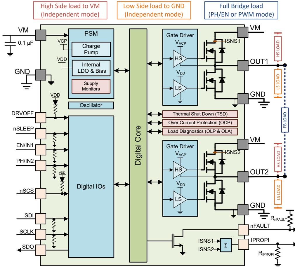
图 7-2. 功能方框图 - SPI (S) 型号
