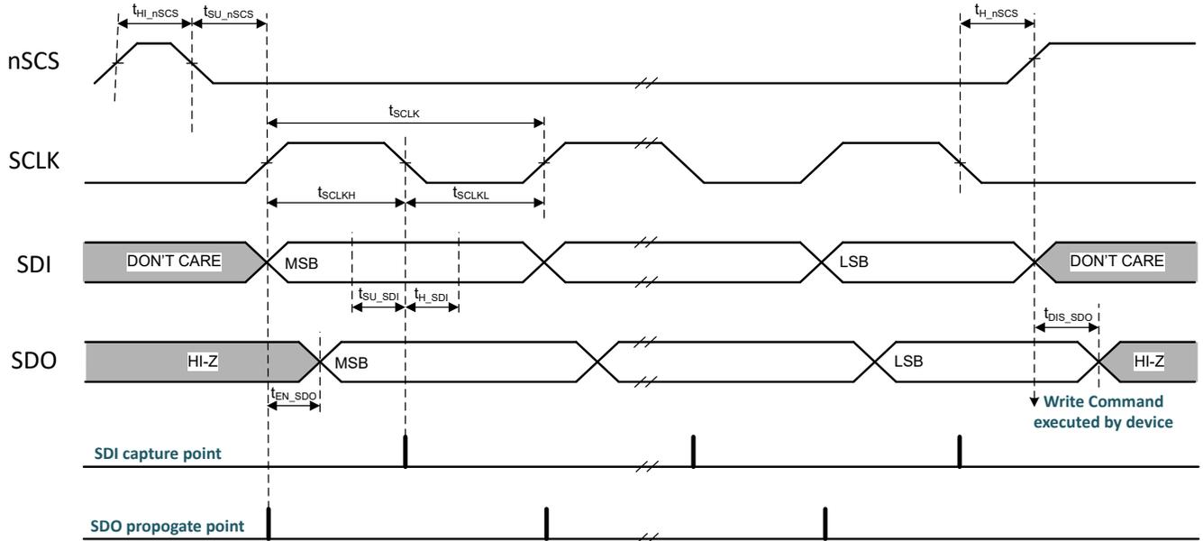
图 6-1. SPI 串行模式时序定义
