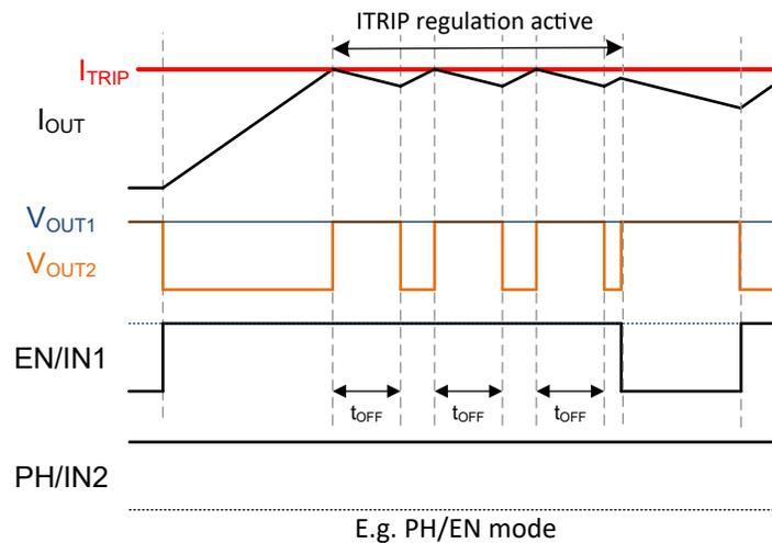
图 7-5. 固定 TOFF ITRIP 电流调节
