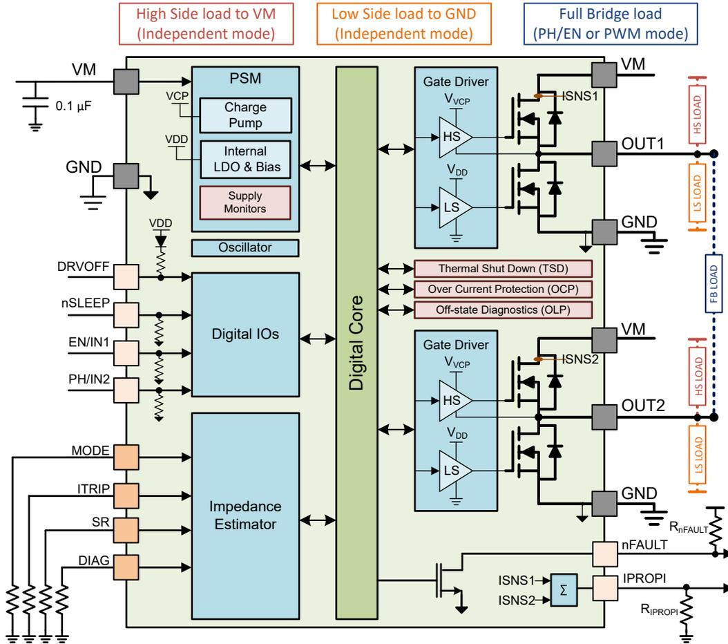
图 7-1. 功能方框图 - HW 型号
