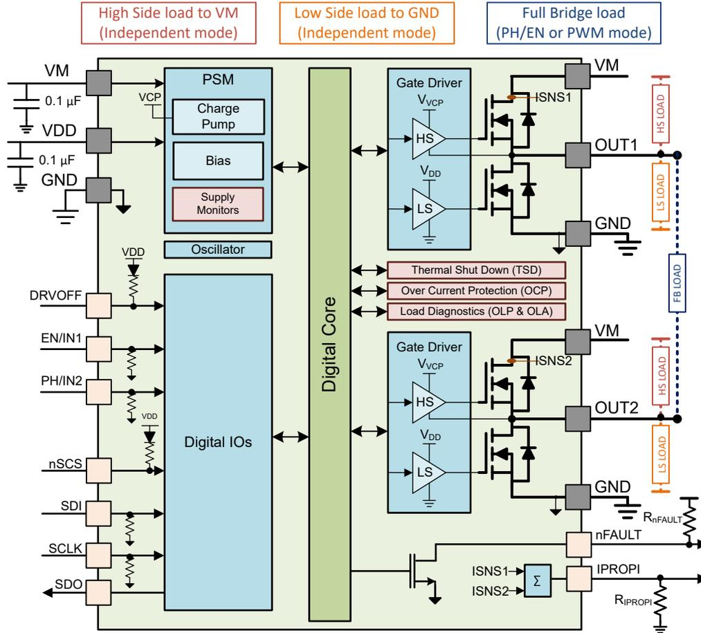
图 7-3. 功能方框图 - SPI (P) 型号
