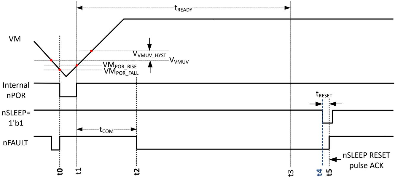
图 6-6. HW 型号从上电至待机状态的转换
