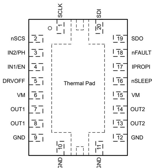
图 5-2. 采用 VQFN (20) 封装的 DRV8242S-Q1 SPI 型号
