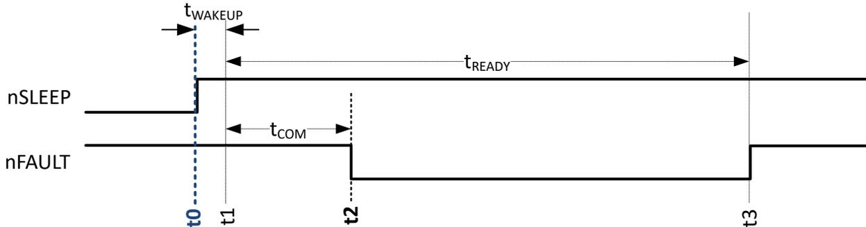
图 6-4. HW 型号从休眠状态唤醒到待机状态的转换 (不带 ACK 脉冲)
