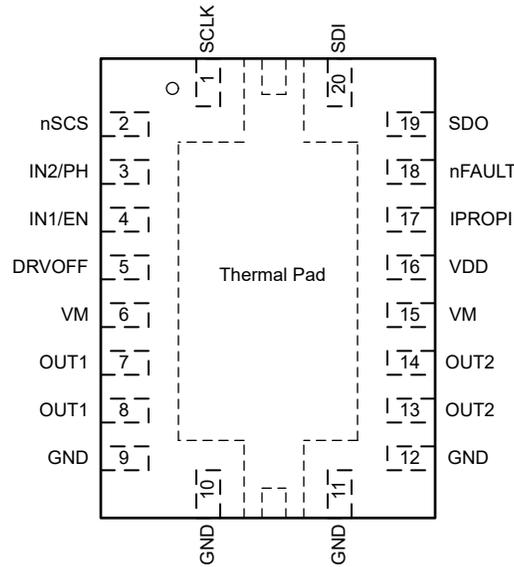
图 5-3. 采用 VQFN (20) 封装的 DRV8242S-Q1 SPI 型号
