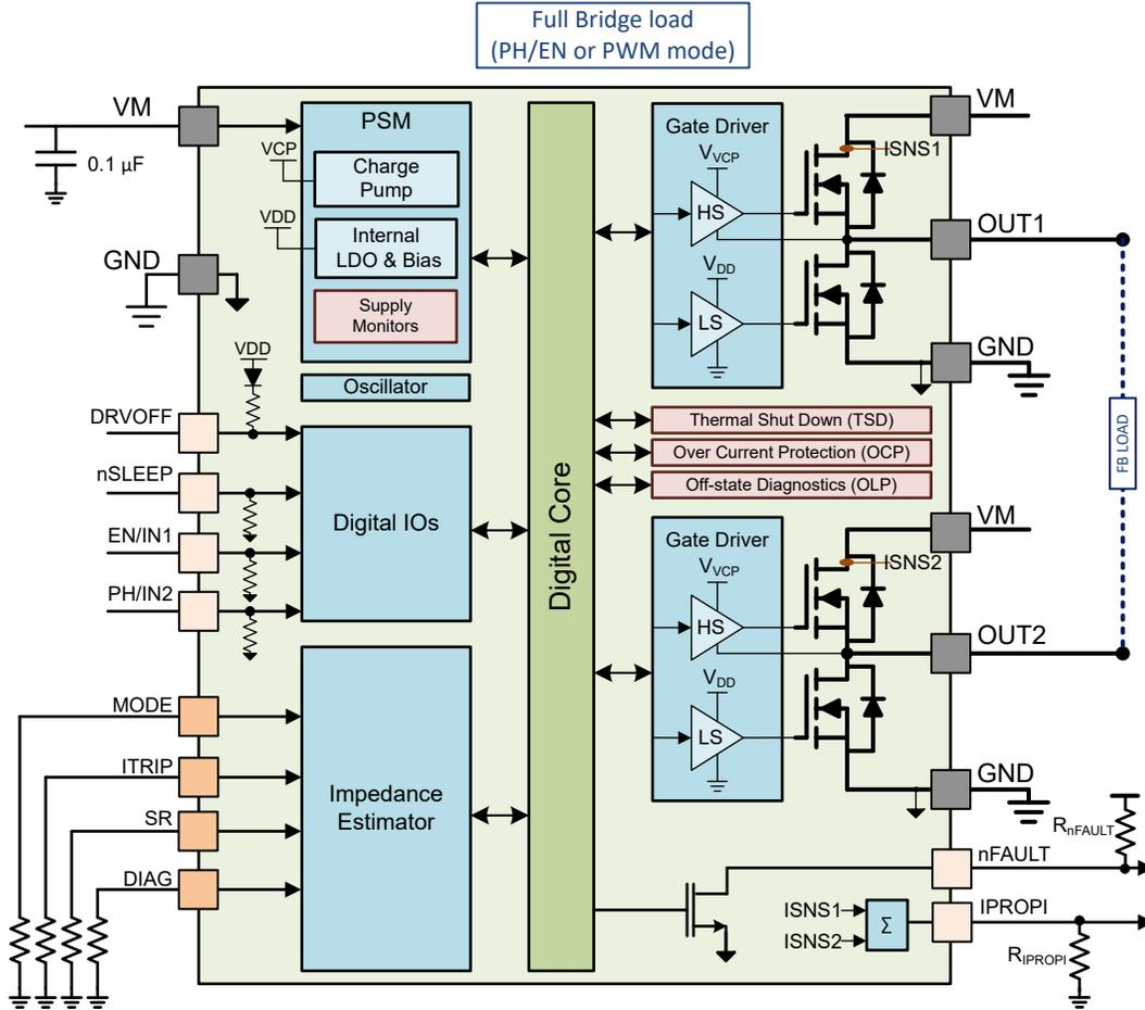
图 7-1. 功能方框图 - HW 型号
