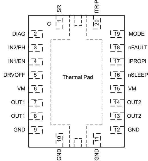
图 5-1. 采用 VQFN (20) 封装的 DRV8242H-Q1 HW 型号
