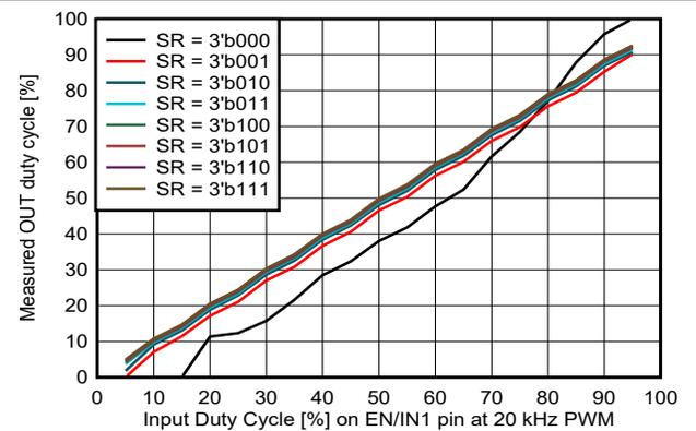
图 6-19. 用于 HS 再循环的  $V_{VM} = 13.5V$  时, PWM 频率为 20KHz 时测得的占空比与输入占空比之间的关系
