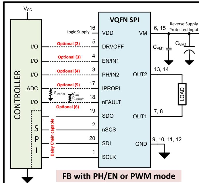
图 9-4. 典型应用原理图 - 采用 VQFN 封装的 SPI (P) 型号
