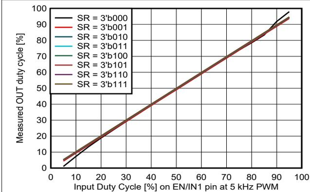
图 6-18. 用于 HS 再循环的  $V_{VM} = 13.5V$  时, PWM 频率为 5KHz 时测得的占空比与输入占空比之间的关系
