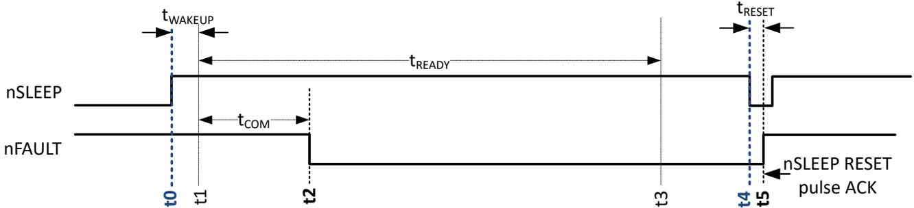
图 6-3. HW 型号从休眠状态唤醒到待机状态的转换 (带 ACK 脉冲)
