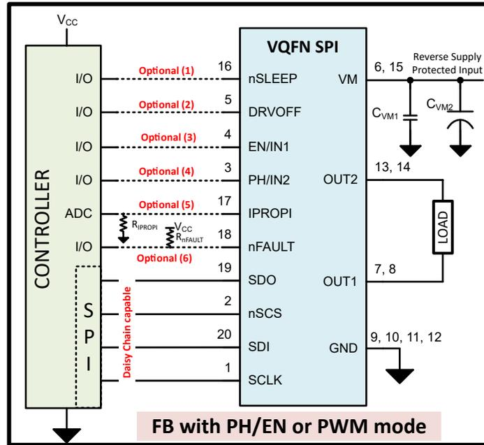
图 9-3. 典型应用原理图 - 采用 VQFN 封装的 SPI (S) 型号
