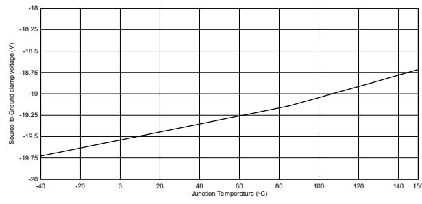
**图 6-6. 源极至接地钳位电压**
