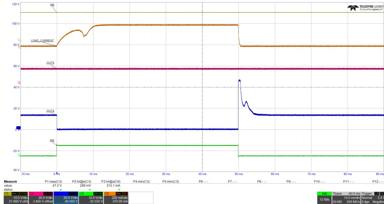
图 8-1. 来自 IN0 引脚的输出导通/关断
