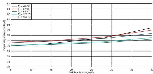
图 6-9. 输出诊断电流,  $VDD = 5.5V$
