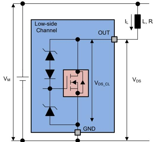
图 7-8. 低侧通道的输出钳位
