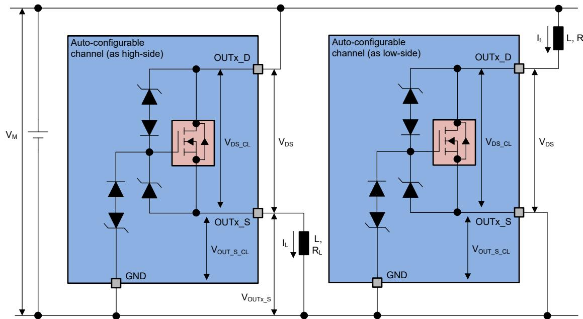
图 7-9. 自动可配置通道的输出钳位
