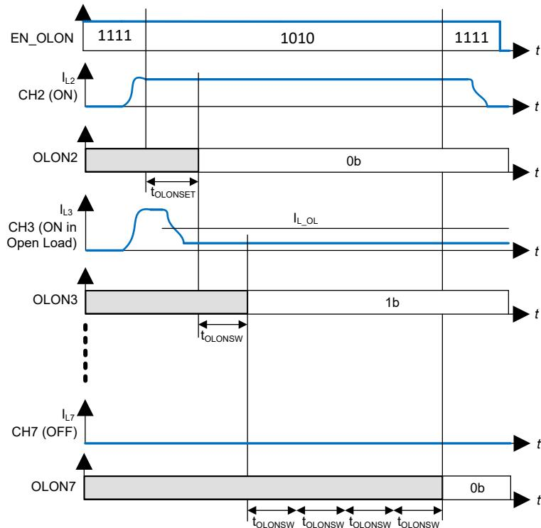
图 7-21. 导通时序时的负载开路 ( 诊断环路 - 由微控制器驱动的通道 )
