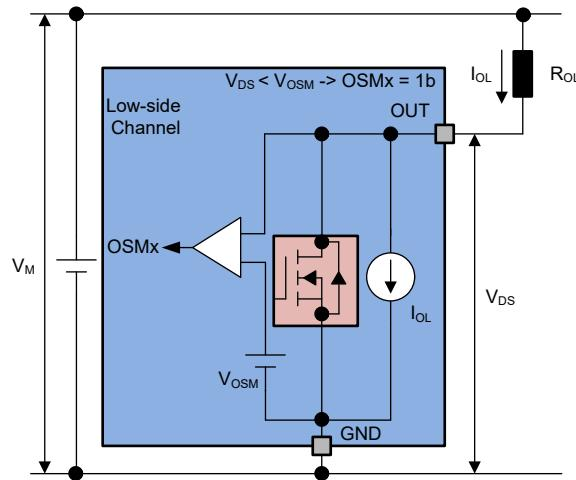
图 7-17. 输出状态监控 - 低侧通道
