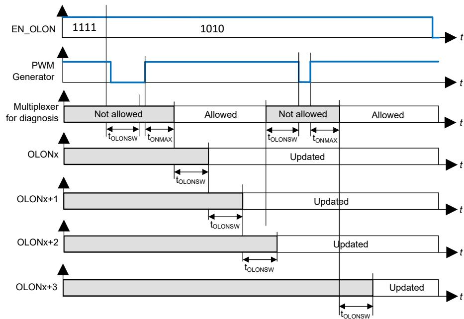
图 7-22. 导通时序时的负载开路 (诊断环路 - 由内部 PWM 发生器驱动的通道)
