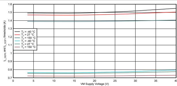
图 6-8. 过流保护阈值,  $VDD = 5.5V$ ,  $OCP = 0b$
