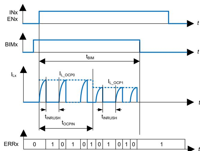
图 7-10. 灯泡浪涌模式 (BIM) 运行
