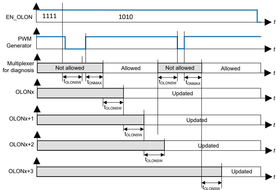
图 7-19. 导通时序时的负载开路 (诊断环路 - 由内部 PWM 发生器驱动的通道)
