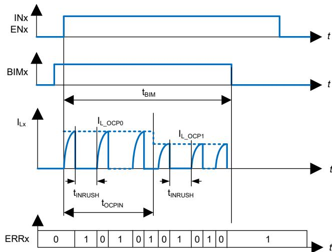
图 7-9. 灯泡浪涌模式 (BIM) 运行
