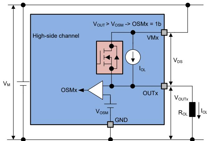
图 7-16. 输出状态监控 - 高侧通道
