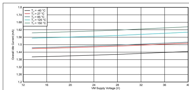
图 6-2. 空闲模式电源电流,  $VDD = 5.5V$
