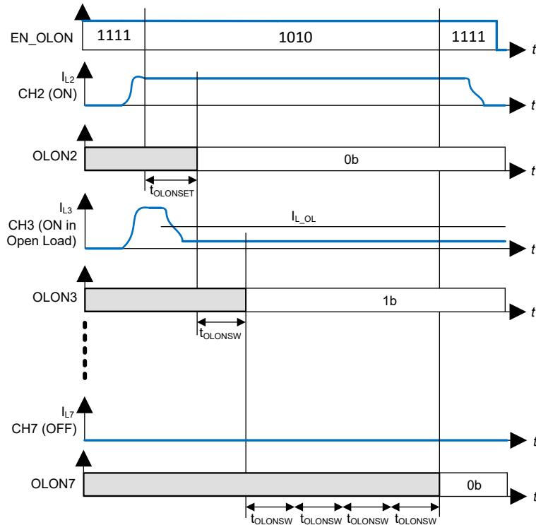
图 7-18. 导通时序时的负载开路 (诊断环路 - 由微控制器驱动的通道)
