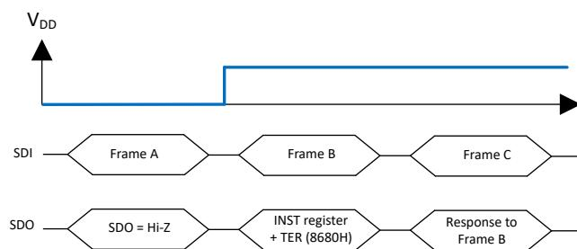
图 7-25. 退出  $V_{DD}$  上电复位后的响应
