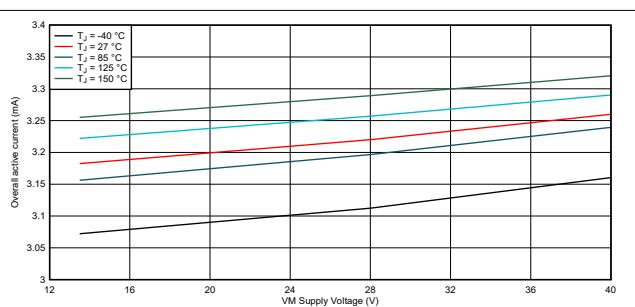
图 6-3. 工作模式电源电流,  $VDD = 5.5V$
