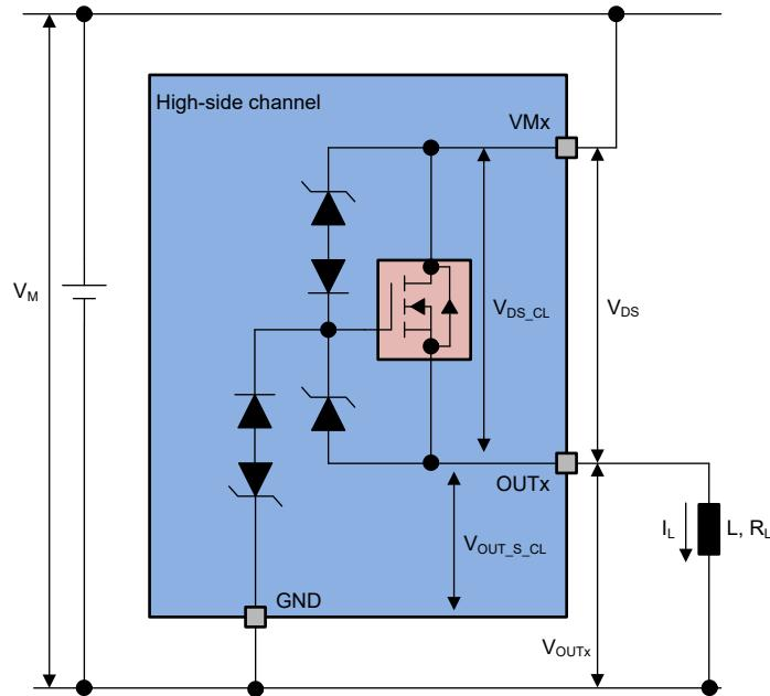
图 7-8. 高侧通道的输出钳位
