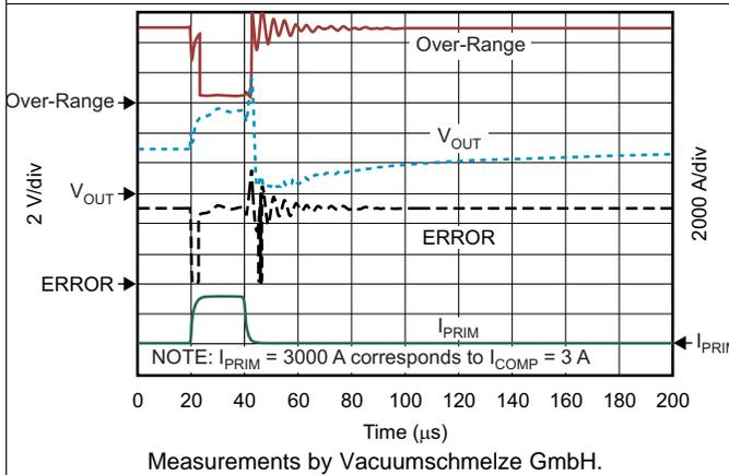
图 5. 3-A  $I_{COMP}$  Overload Recovery
