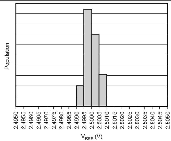
图 28. Voltage Reference Production Distribution
