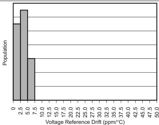
图 29. Voltage Reference Drift Production Distribution
