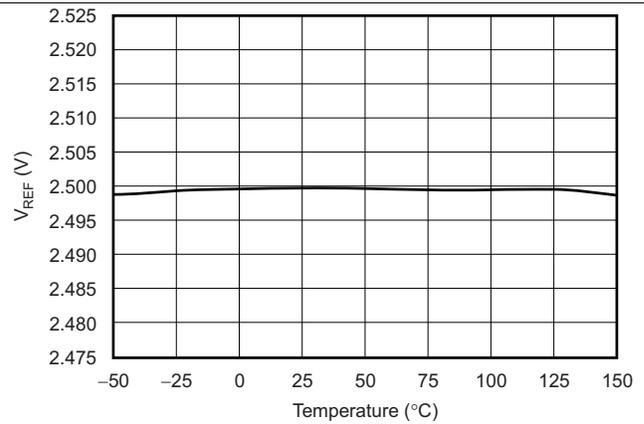
图 30. Voltage Reference vs Temperature
