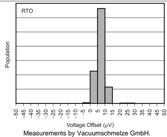
图 6. Differential Amplifier: Voltage Offset Production Distribution
