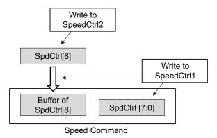
图 24. I<sup>2</sup>C Mode Speed Control
