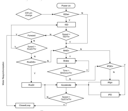
图 11. Motor Starting-Up Flow
