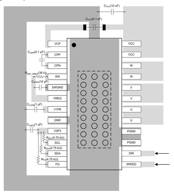
图 42. Example Layout Diagram for HTSSOP Package
