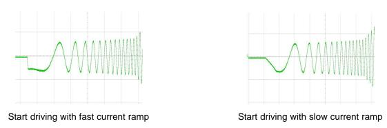
图 20. Motor Startup Current Ramp
