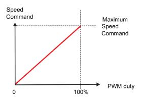
图 23. PWM Mode Speed Command
