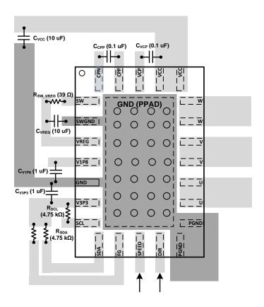
图 43. Example Layout Diagram for VQFN Package
