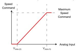
图 22. Analog Mode Speed Command
