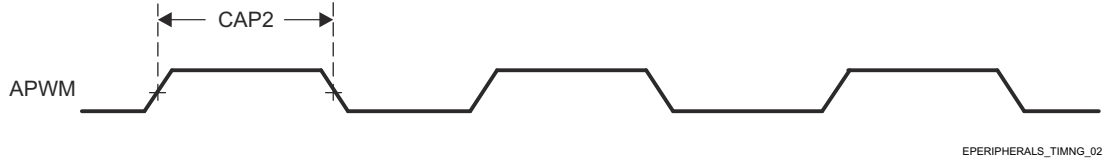
图 7-51. ECAP Output Timings
