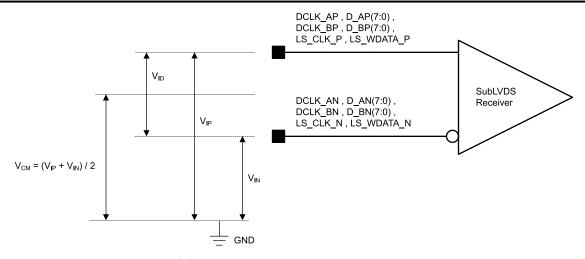
图 6-6. SubLVDS Voltage Parameters
