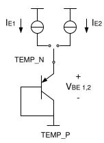
图 7-2. Temperature Measurement Theory
