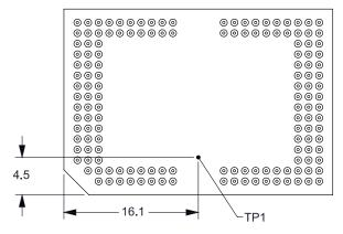
图 7-4. DMD Thermal Test Points
