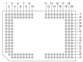
图 5-1. FYS Package 149-Pin CPGA Bottom View
