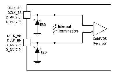
图 6-8. SubLVDS Equivalent Input Circuit
