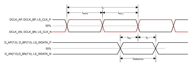
图 6-4. SubLVDS Switching Parameters
