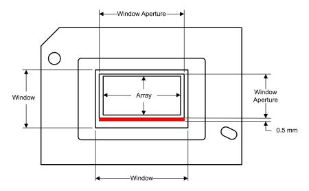
图 6-1. Illumination Overfill Diagram
