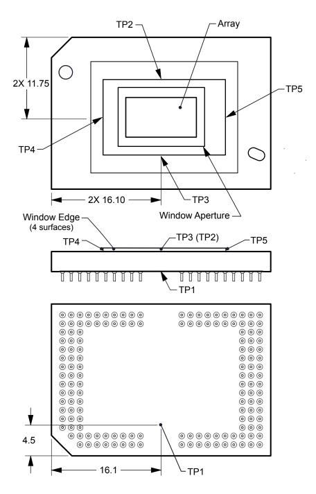
图 7-1. DMD Thermal Test Points
