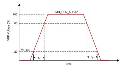
图 6-9. LVCMOS Rise, Fall Time Slew Rate
