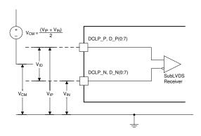
图 6-9. SubLVDS Voltage Parameters
