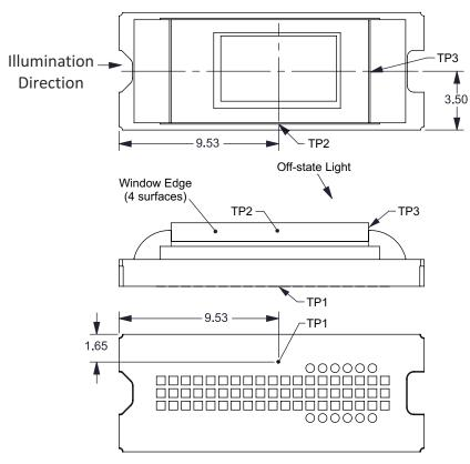
图 7-1. DMD Thermal Test Points
