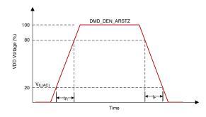
图 6-4. LPSDR Input Slew Rate
