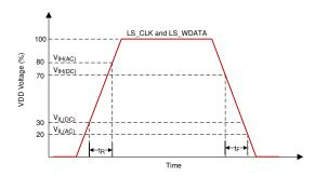
图 6-3. LPSDR Input Slew Rate
