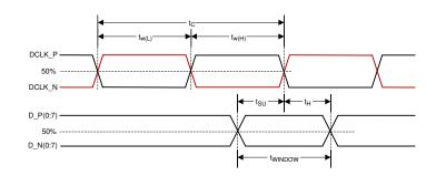
图 6-7. SubLVDS Switching Parameters
