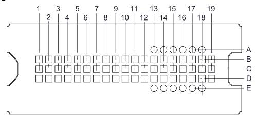
图 5-1. FQK Package 57-Pin LGA (Bottom View)
