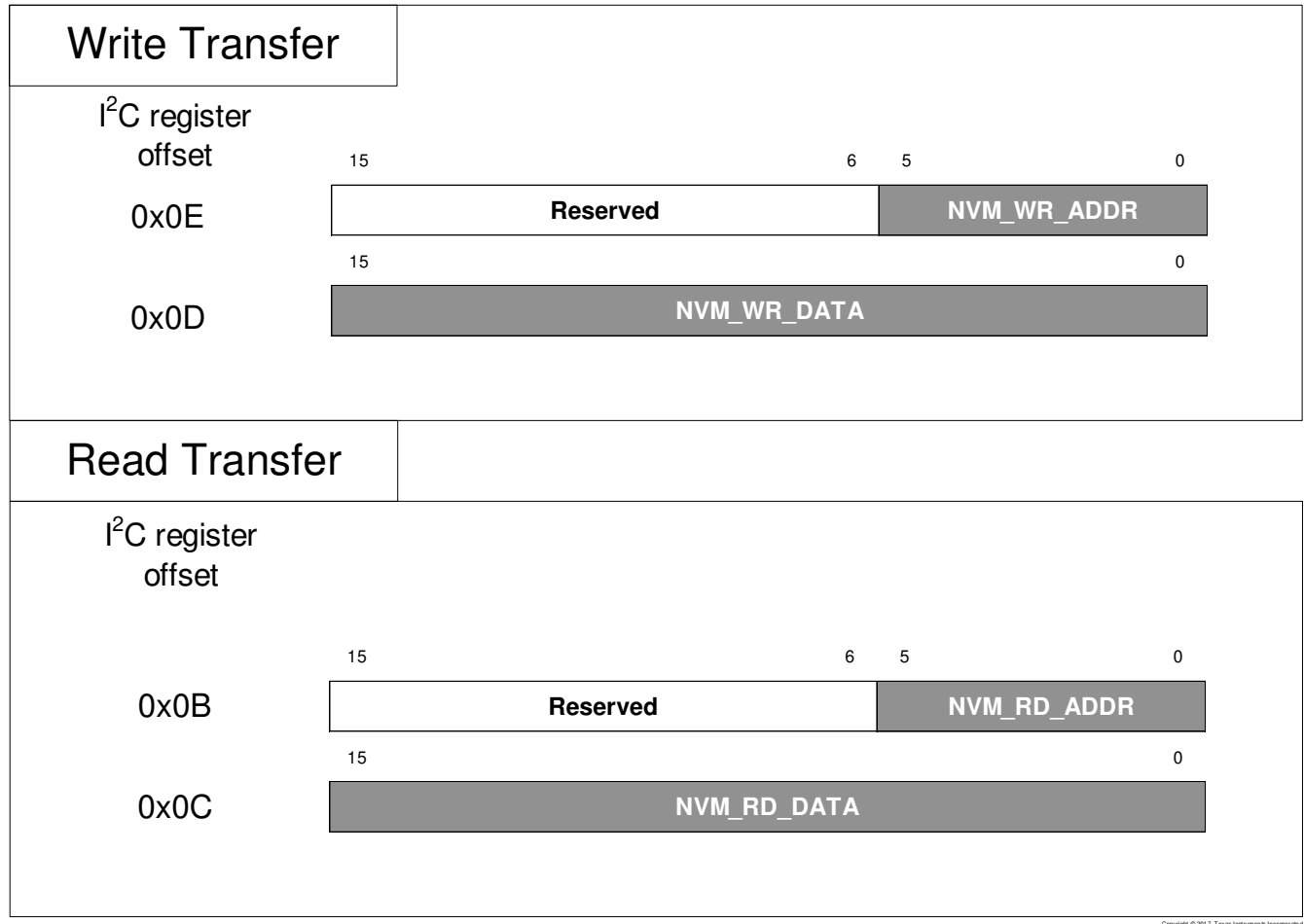
图 7-12. 使用 I 2 C 的 EEPROM 直接访问
