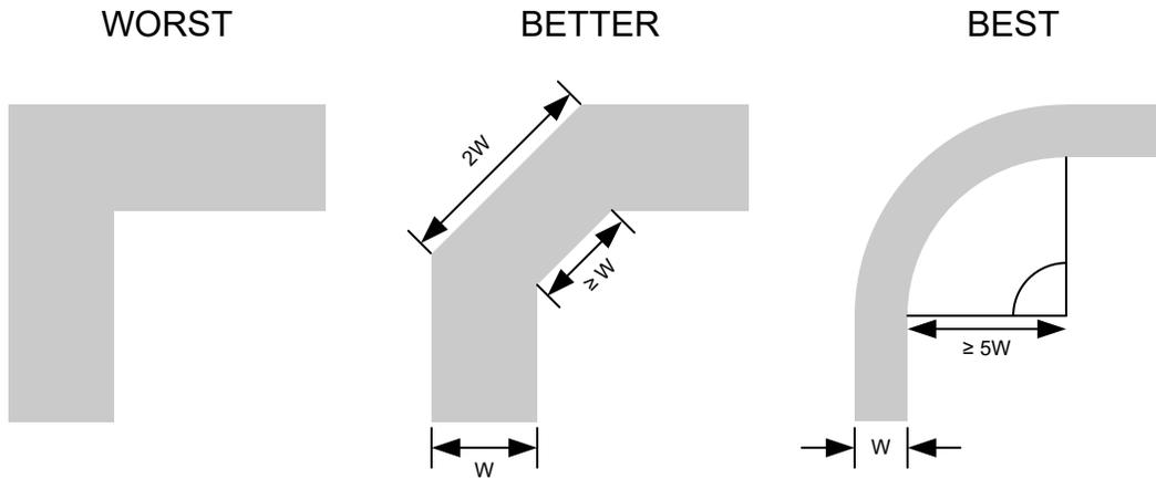
图 8-3. 可改善信号完整性的布线转角示例
