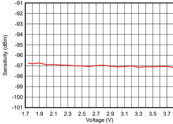
图 7-20. 灵敏度与电源电压 (VDD5) 间的关系 ( BLE 1Mbps , 2.44GHz , 禁用直流/直流转换器 )
