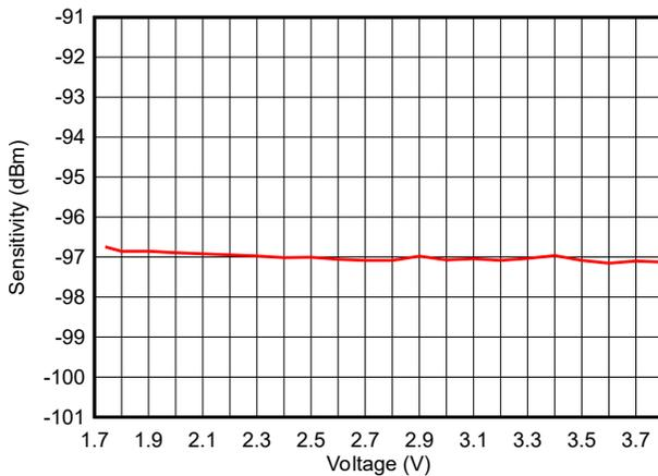
图 7-18. 灵敏度与电源电压 (VDD5) 间的关系 (BLE 1Mbps , 2.44GHz )
