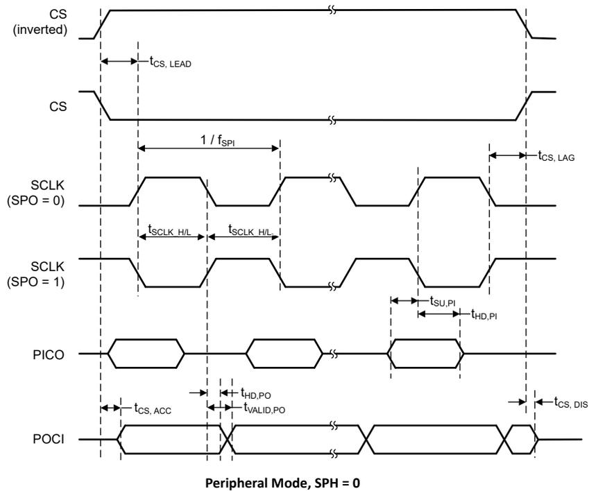
图 7-3. SPI 计时示意图 - 外设模式，SPH = 0
