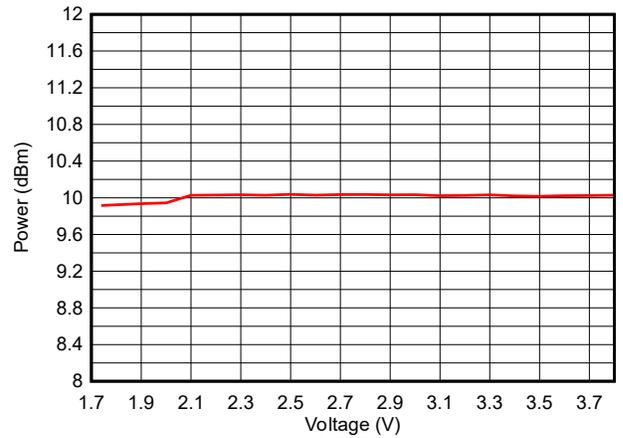
图 7-25. 输出功率与电源电压 (VDD5) 间的关系 ( BLE 1Mbps , 2.44GHz , +10dBm )
