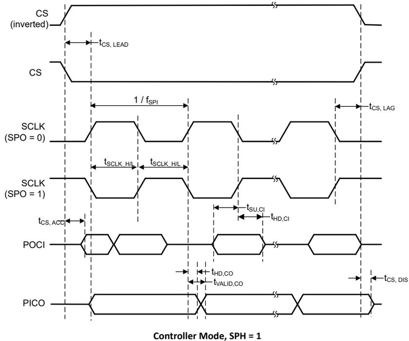
图 7-2. SPI 计时示意图 - 控制器模式，SPH = 1
