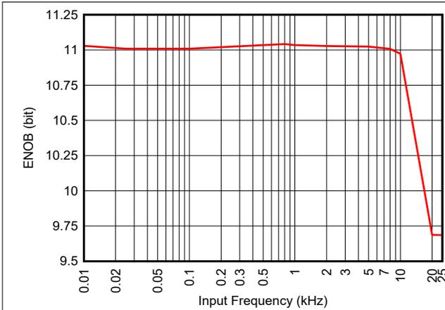
图 7-28. ENOB 与输入频率间的关系 ( 内部基准 )
