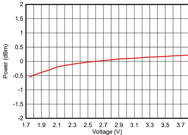
图 7-24. 输出功率与电源电压 (VDD5) 间的关系 ( BLE 1Mbps , 2.44GHz , 0dBm )
