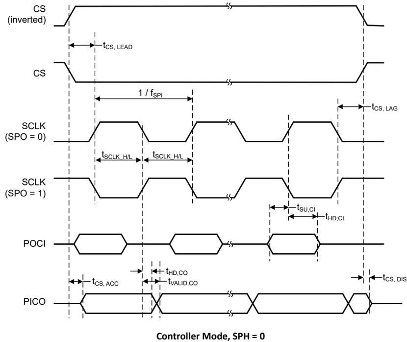
图 7-1. SPI 计时示意图 - 控制器模式，SPH = 0
