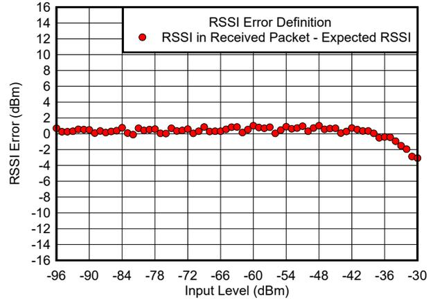
图 7-21. RSSI 误差与输入电平间的关系 (dBm)
