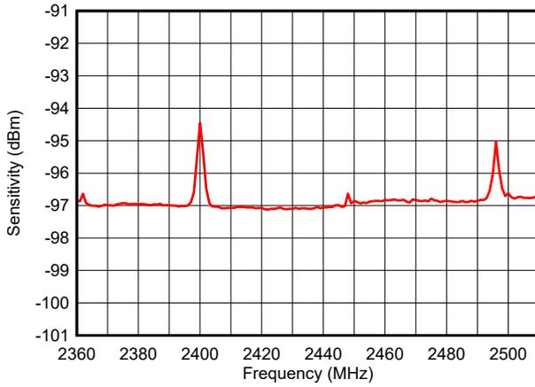
图 7-14. 灵敏度与频率间的关系 (BLE 1Mbps)
