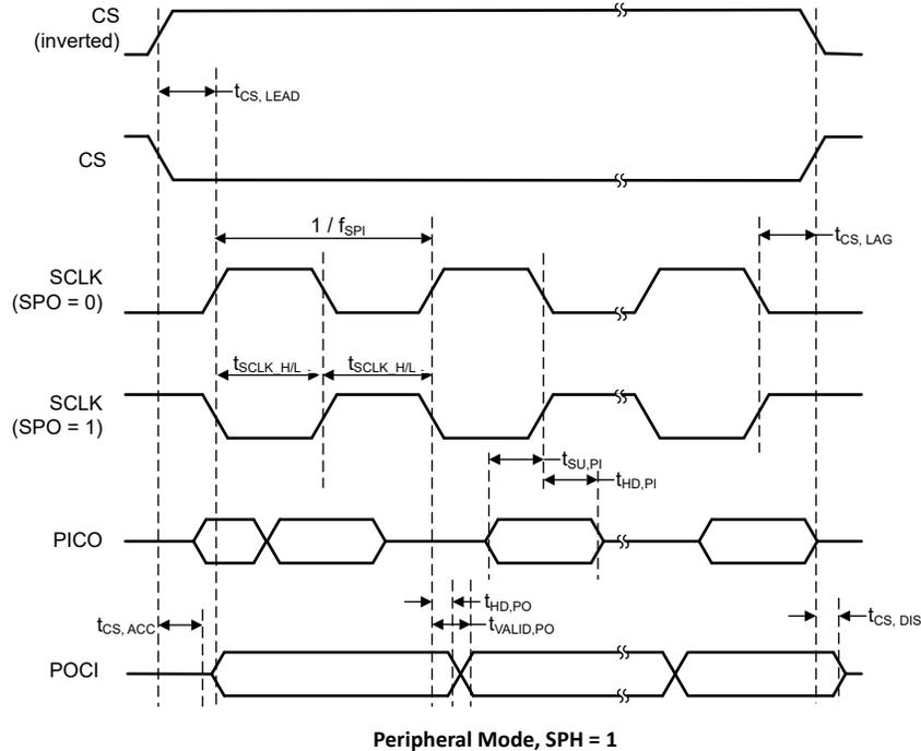
图 7-4. SPI 计时示意图 - 外设模式，SPH = 1
