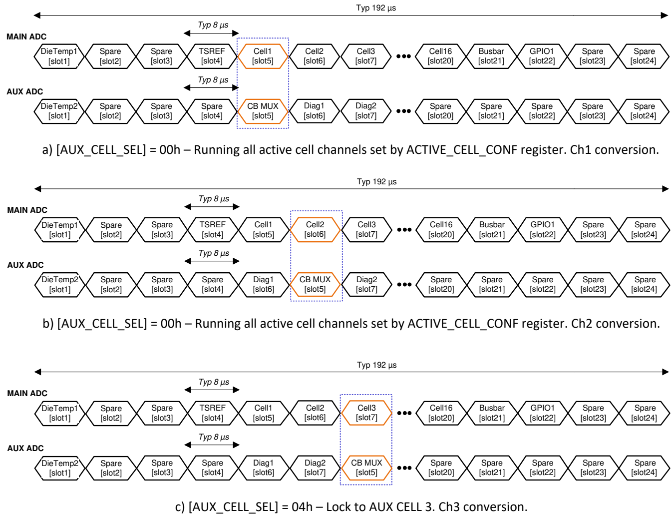
图 6-12. 主 ADC 和 AUX ADC 采样之间的同步
