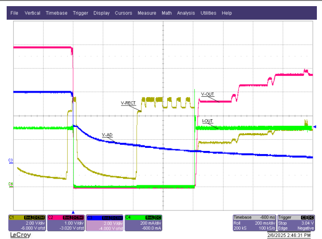
图 9-6. 在有线电源和无线电源之间转换 (EN1 = EN2 = 低电平)
