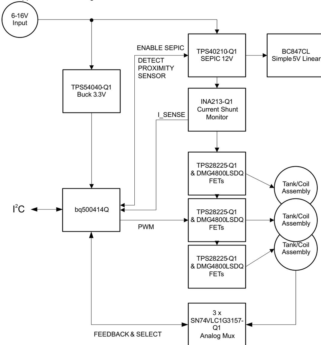
图 9. bq500414Q System Diagram
