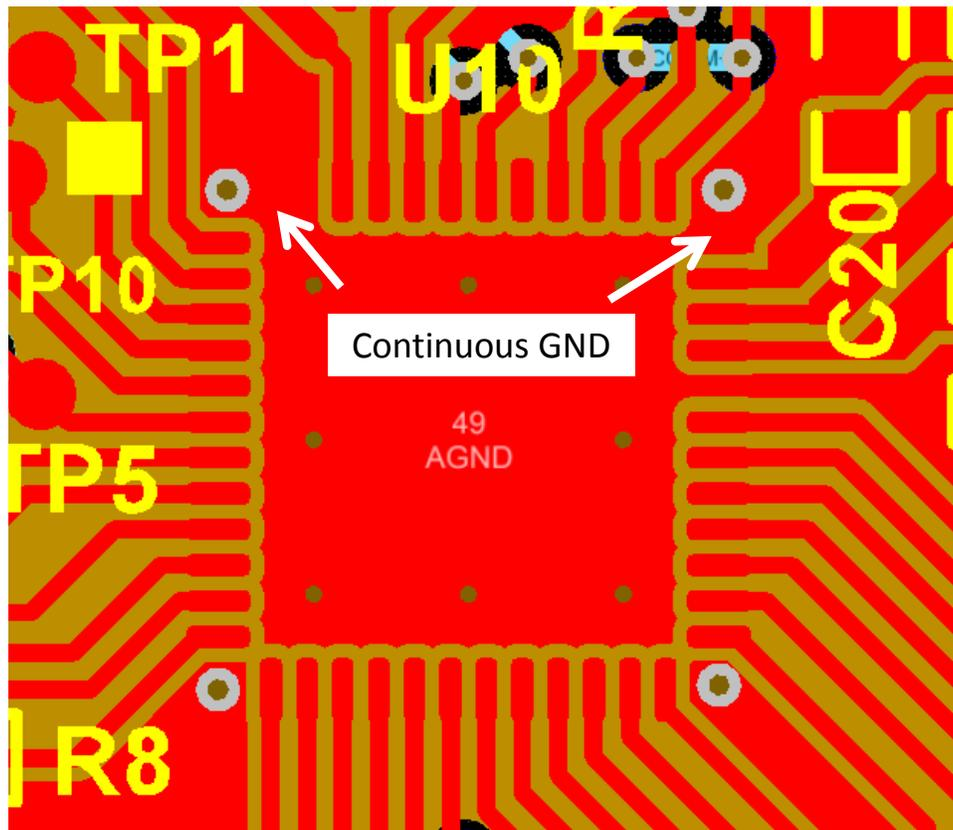
图 16. Continuous GND Layout
