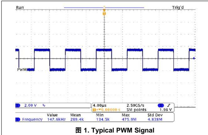
图 1. Typical PWM Signal
