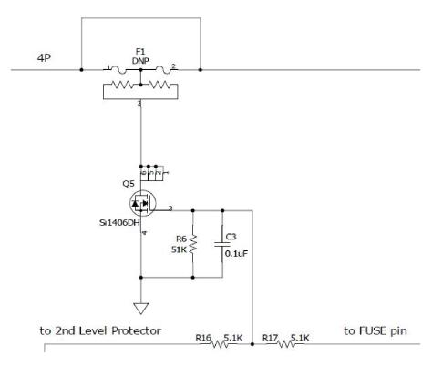
图 23. FUSE Circuit
