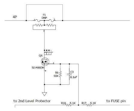
图 31. FUSE Circuit
