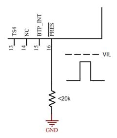
图 28. System Present Pull-Down Resistor
