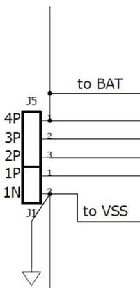
图 24. Lithium-Ion Cell Connections
