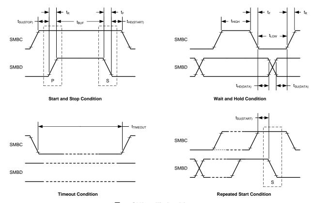
图 4. SMBus Timing Diagram
