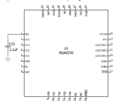
图 27. Power Supply Decoupling
