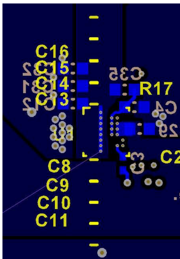
图 12-2. BQ25968 Layout Example - Bottom Layer
