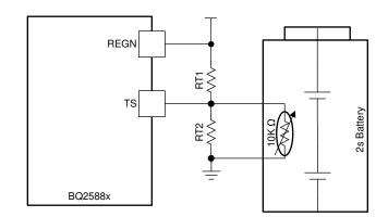
图 23. TS Resistor Network
