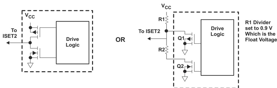
图 8-6. 3-State ISET2 Terminal Circuits
