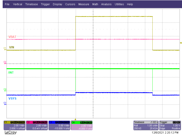
图 9-11. /INT 上的电源正常中断
