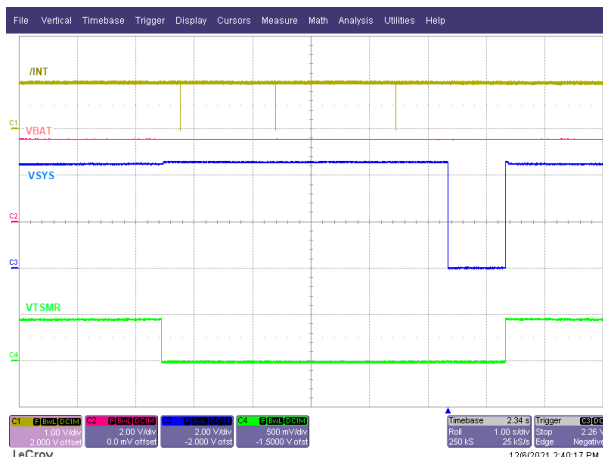
图 9-15. 存在 VIN 时的 Wake1 中断
