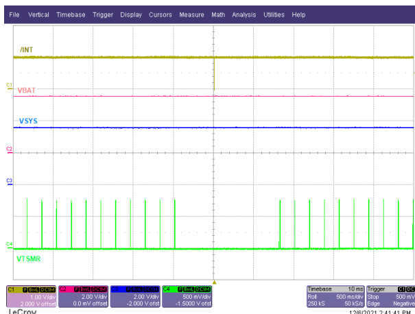
图 9-18. 没有 VIN 时的 Wake1 中断
