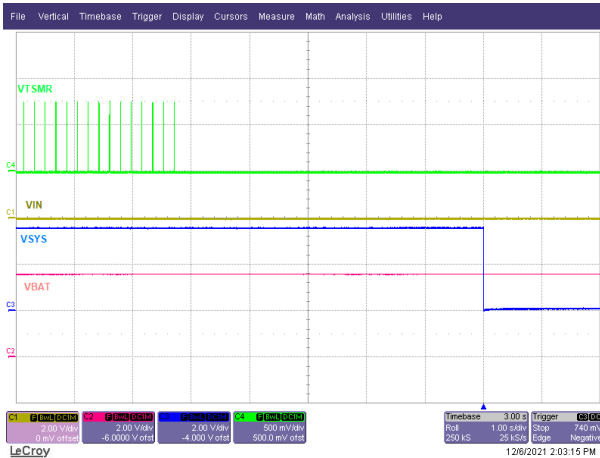
图 9-10. 移除 VIN 时进入运输模式
