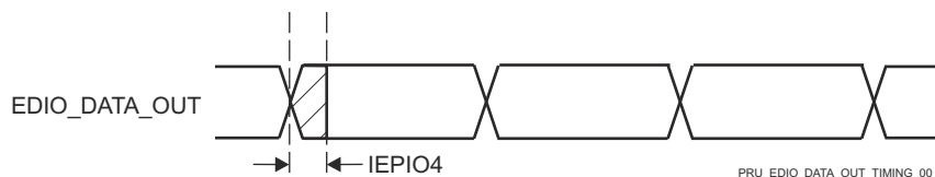
图 6-101. PRU_ICSSG IEP 数字 IO 时序要求
