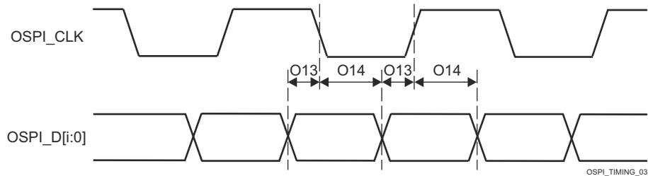
图 6-108. OSPI0 时序要求 - Tap DDR，无环回
