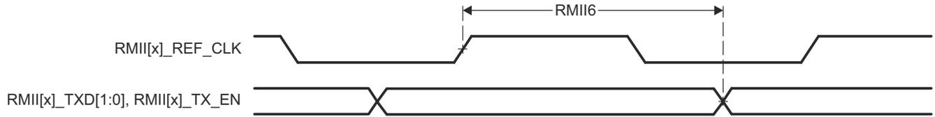
图 6-29. RMII[x]\_TXD[1:0] 和 RMII[x]\_TX\_EN 开关特性 - RMII 模式
