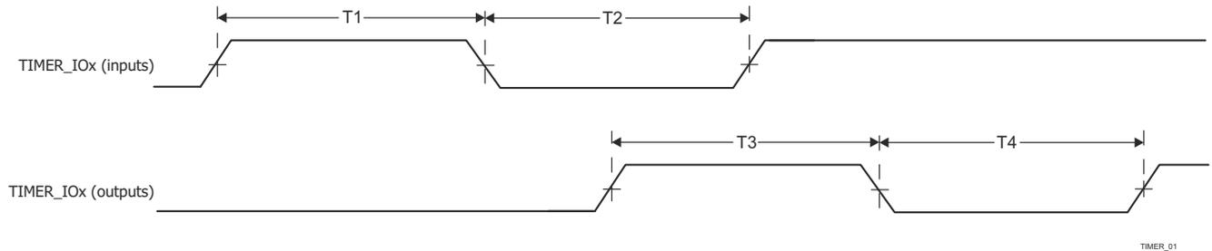
**图 6-110. 计时器时序要求和开关特性**
