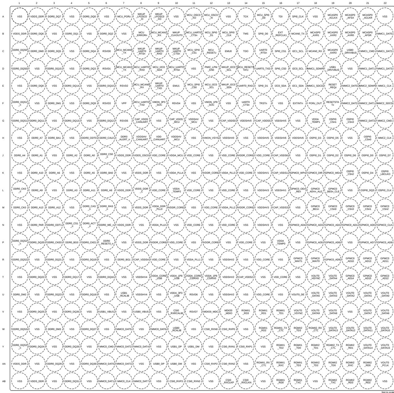
图 5-1. AMB FCBGA 和 ANF FCCSP 引脚图 (顶视图)
