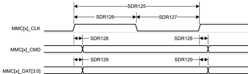
图 6-91. MMC1/MMC2 - UHS-I SDR12 - 发送模式
