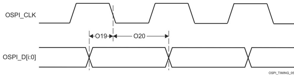
**图 6-106. OSPI0 时序要求 - Tap SDR , 无环回**
