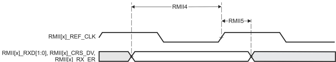
图 6-28. CPSW3G RMII[x]\_RXD[1:0]、RMII[x]\_CRS\_DV、RMII[x]\_RX\_ER 时序要求 - RMII 模式
