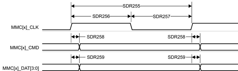
图 6-93. MMC1/MMC2 - UHS-I SDR25 - 发送模式
