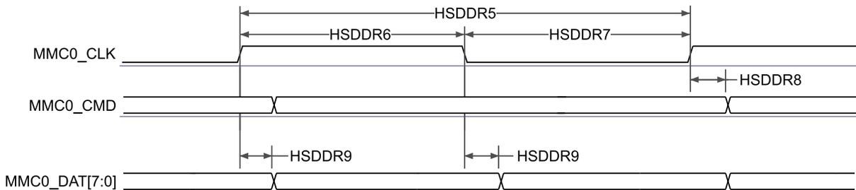
图 6-72. MMC0 - 高速 DDR 模式 - 发送模式
