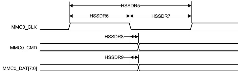
图 6-70. MMC0 - 高速 SDR 模式 - 发送模式
