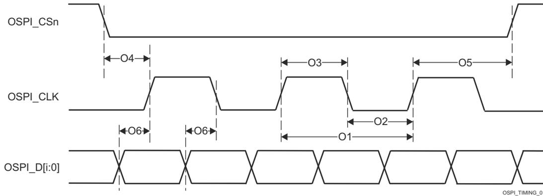
图 6-109. OSPI0 开关特性 - Tap DDR, 无环回
