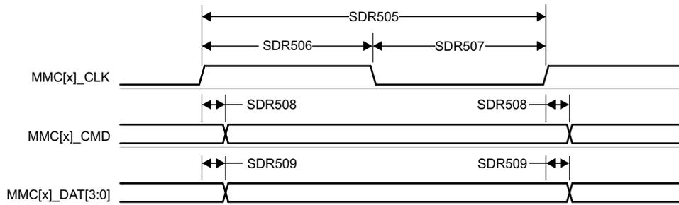
图 6-94. MMC1/MMC2 - UHS-I SDR50 - 发送模式
