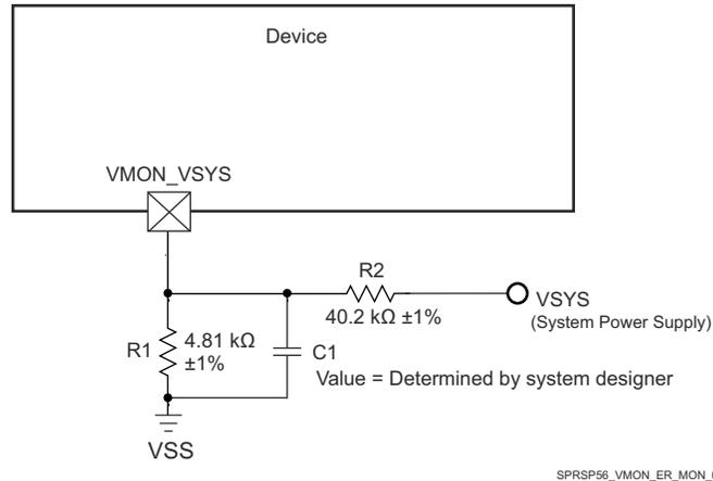
图 8-5. 系统电源监测分压器电路
