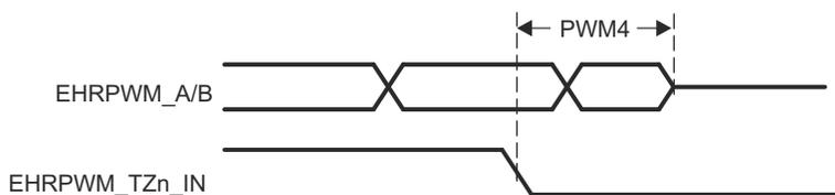
图 6-44. EHRPWM\_TZn\_IN 至 EHRPWM\_A/B 高阻态开关特性
