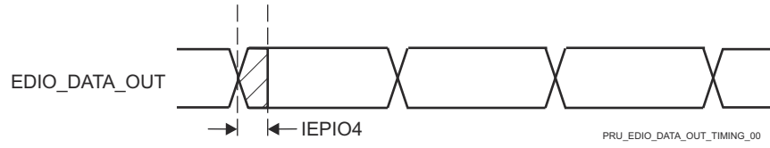
图 6-76. PRU-ICSS IEP 数字 IO 时序要求
