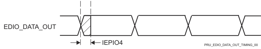
图 6-76. PRU-ICSS IEP 数字 IO 时序要求
