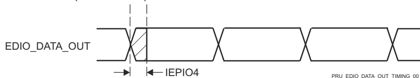
图 6-98. PRU_ICSSG IEP 数字 IO 时序要求
