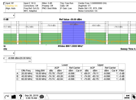
3.5GHz 匹配, 单载波 20MHz BW TM1.1 LTE
