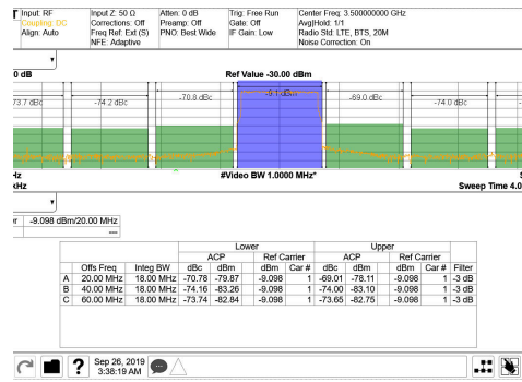
3.5GHz 匹配, 单载波 20MHz BW TM1.1 LTE
