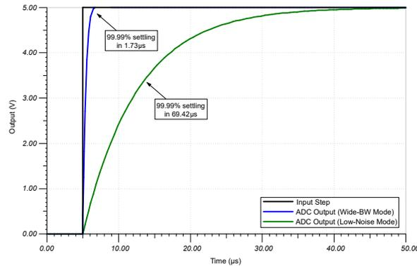
**Figure 8-3. Step-Settling Performance**
