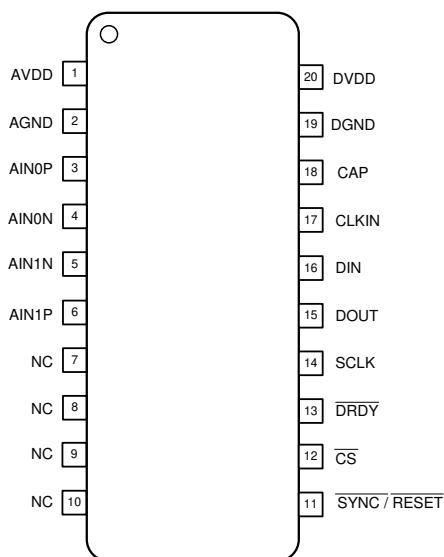
图 5-1. PW Package, 20-Pin TSSOP (Top View)
