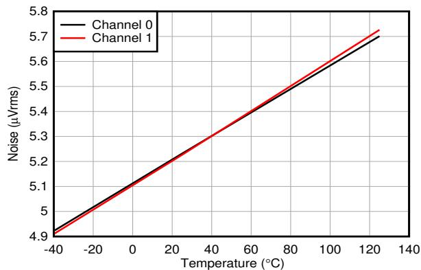
图 6-20. Noise vs Temperature
