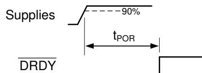
图 6-3. Power-On-Reset Timing
