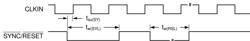
图 6-2. SYNC/RESET Timing Requirements
