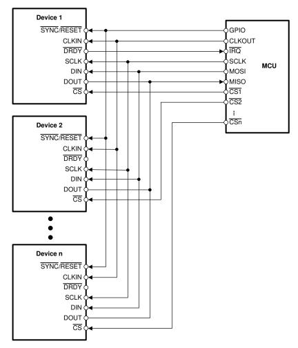
图 9-3. Multiple Device Configuration
