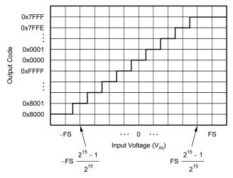
图 8-17. Code Transition Diagram
