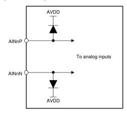
图 8-1. Input ESD Protection Circuitry
