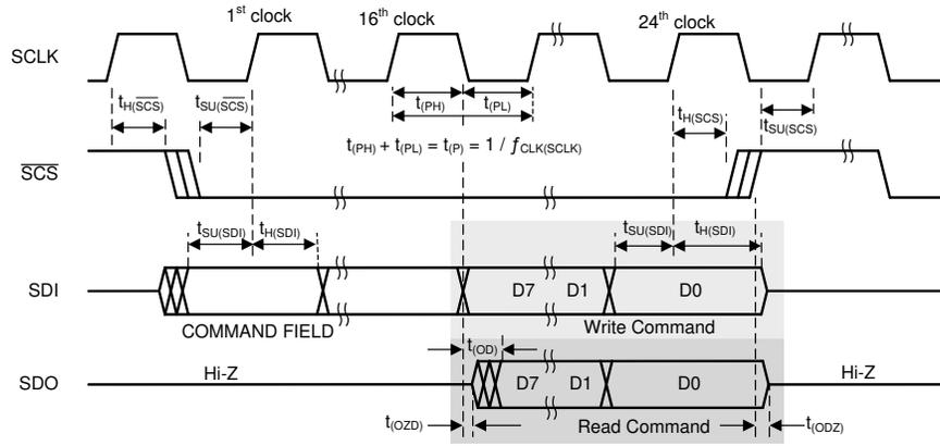
**图 6-3. Serial Interface Timing**
