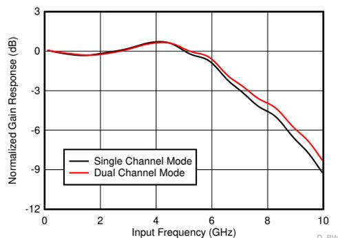
ADC12DJ3200QML-SP 测量的输入带宽
