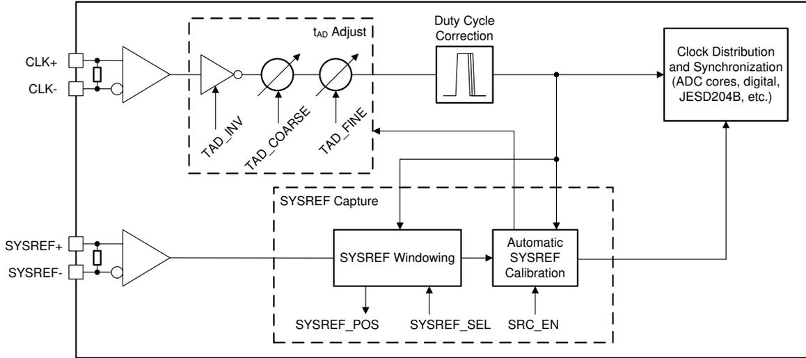
图 7-3. ADC12DJ3200QML-SP Clocking Subsystem
