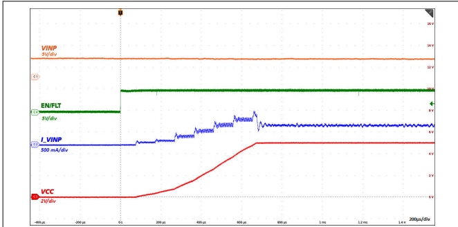
图 6-13. 通过 EN/FLT 从低电平到高电平启动 : VINP = 5.0V , VCC = 5.0V , 18Ω 负载
