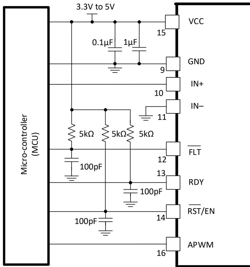
图 8-3.  $\overline{\text{FLT}}$ ,  $\text{RDY}$  and  $\overline{\text{RST/EN}}$  Pins Circuitry
