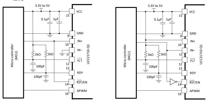
图 8-4. Automatic Reset Control
