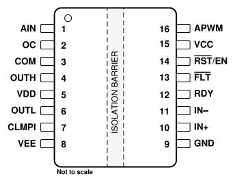
图 4-1. UCC21710-Q1 DW SOIC (16) Top View
