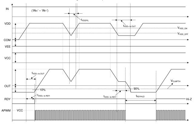
图 6-9. VDD UVLO Protection Timing Diagram
