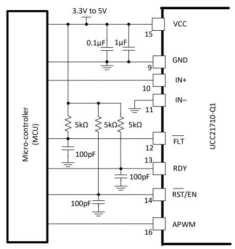
图 8-3. FLT, RDY and RST/EN Pins Circuitry
