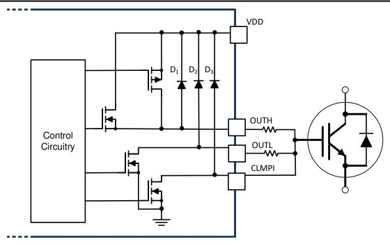
图 7-3. Short Circuit Clamping
